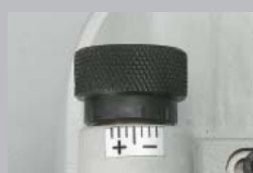
1. Índice copiator con regulación micrométrica
