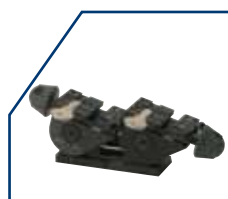
1 Mordças basculantes para a duplicação de chaves de pontos, de canais, especiais e tubulares.
