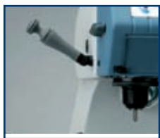
2 Dispositivo con muelle palpador.
