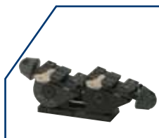
1 Etau à bascule pour la duplication de clés à points, spéciales et tubulaires.
